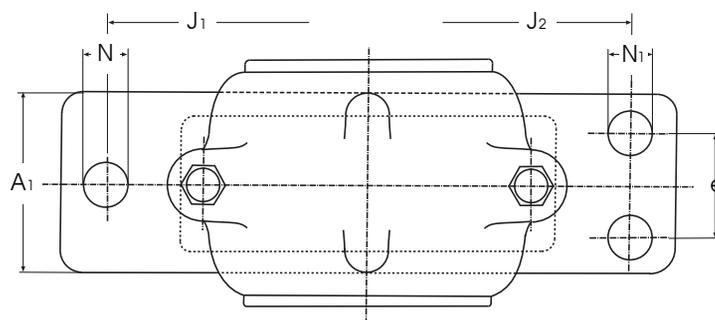
Die Lieferung erfolgt standardmäßig ohne Fußlochbohrungen. Auf Wunsch werden wahlweise zwei oder vier Anschraublöcher gemäß Maßtabelle angebracht. Werkstoff GGG 40 + GS 45
