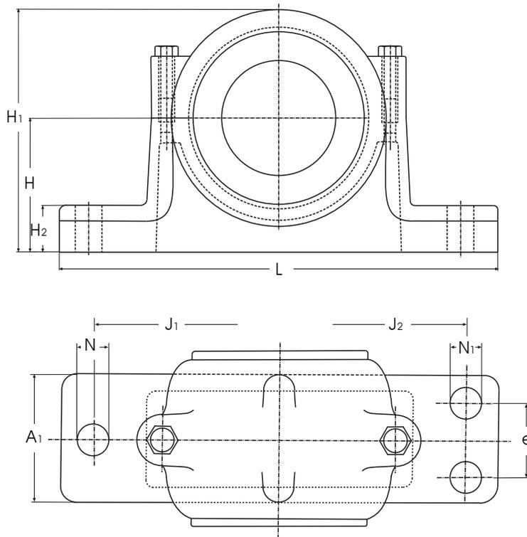
Die Lieferung erfolgt standardmäßig ohne Fußlochbohrungen. Auf Wunsch werden wahlweise zwei oder vier Anschraublöcher gemäß Maßtabelle angebracht. Werkstoff GGG 40 + GS 45
