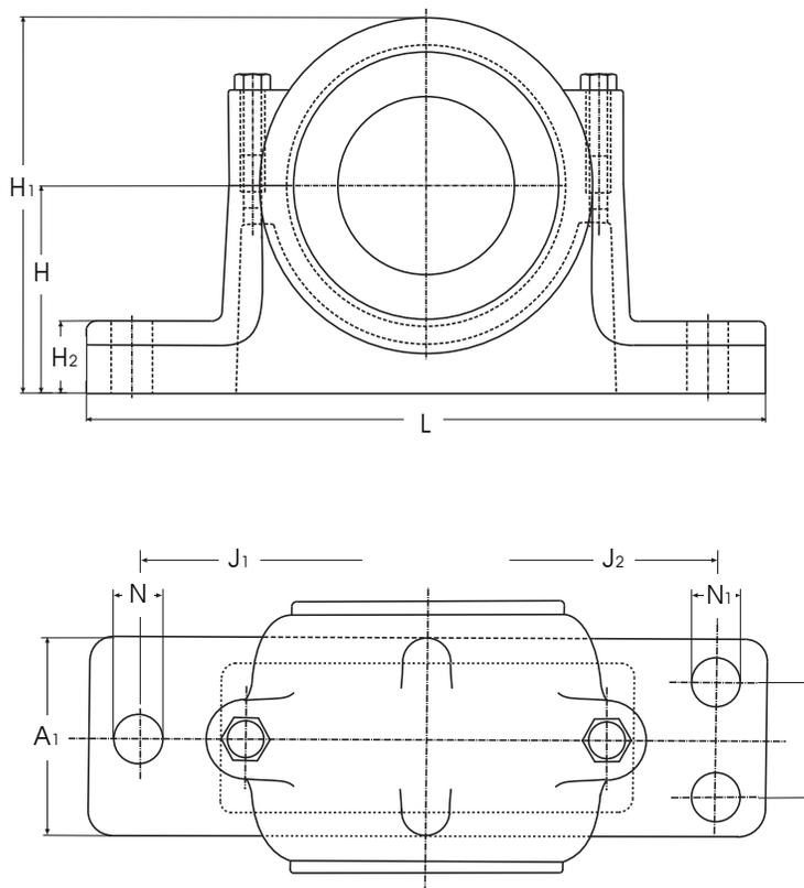
Die Lieferung erfolgt standardmäßig ohne Fußlochbohrungen. Auf Wunsch werden wahlweise zwei oder vier Anschraublöcher gemäß Maßtabelle angebracht. Werkstoff GGG 40 + GS 45
